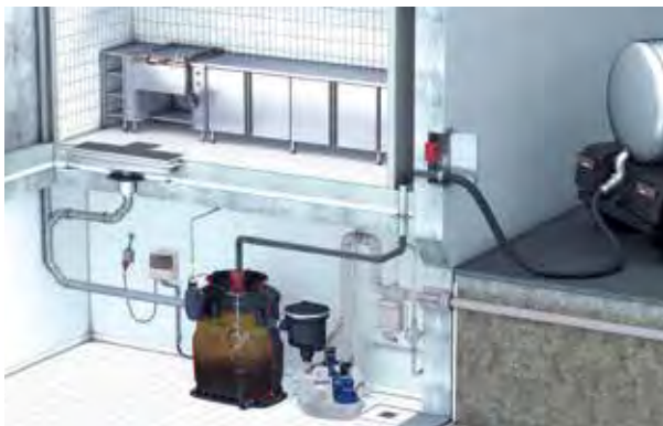
Fettabscheider, die unterhalb der Rückstauenebene eingebaut sind, müssen mit einer Hebeanlage (mit Rückstauschleife) an die Kanalisation angeschlossen sein.
